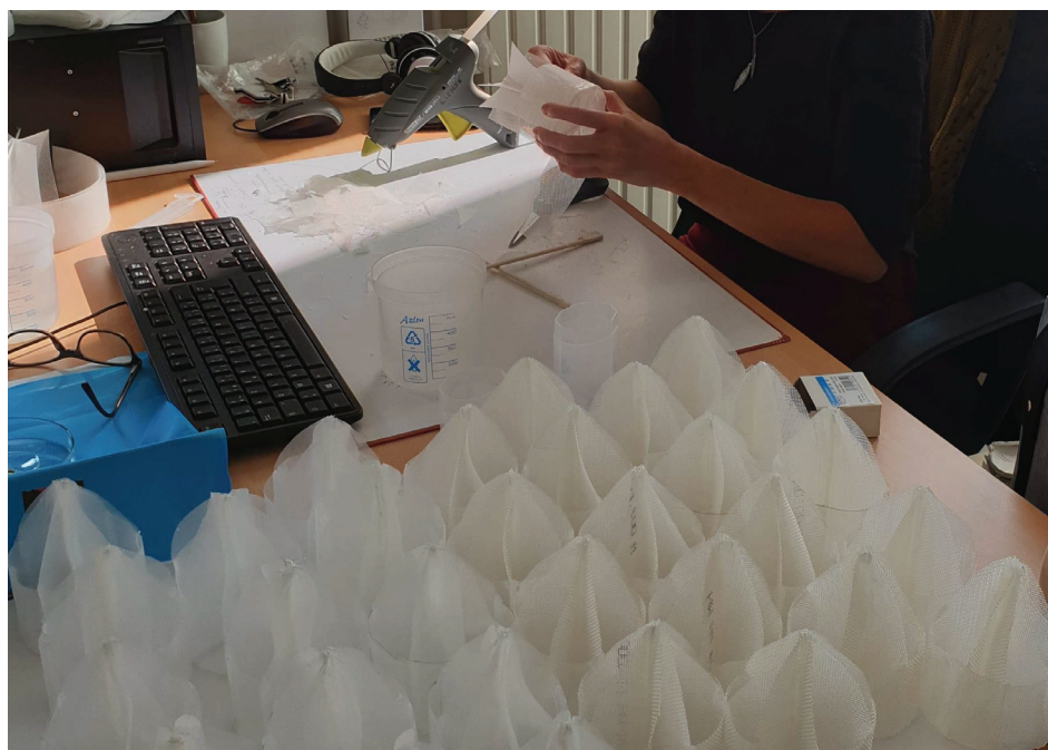
Figure II-9. Photographie du processus manuel de fabrication des paniers d'individualisation des gammes.
