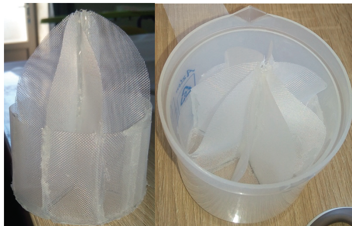
Figure II-8. Photographie d'un dispositif de paniers comprenant 8 compartiments d'individualisation.
