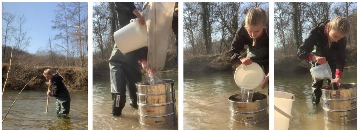
Figure II-4 : Illustration pour le prélèvement des populations de gammares par la méthode du kick sampling.
