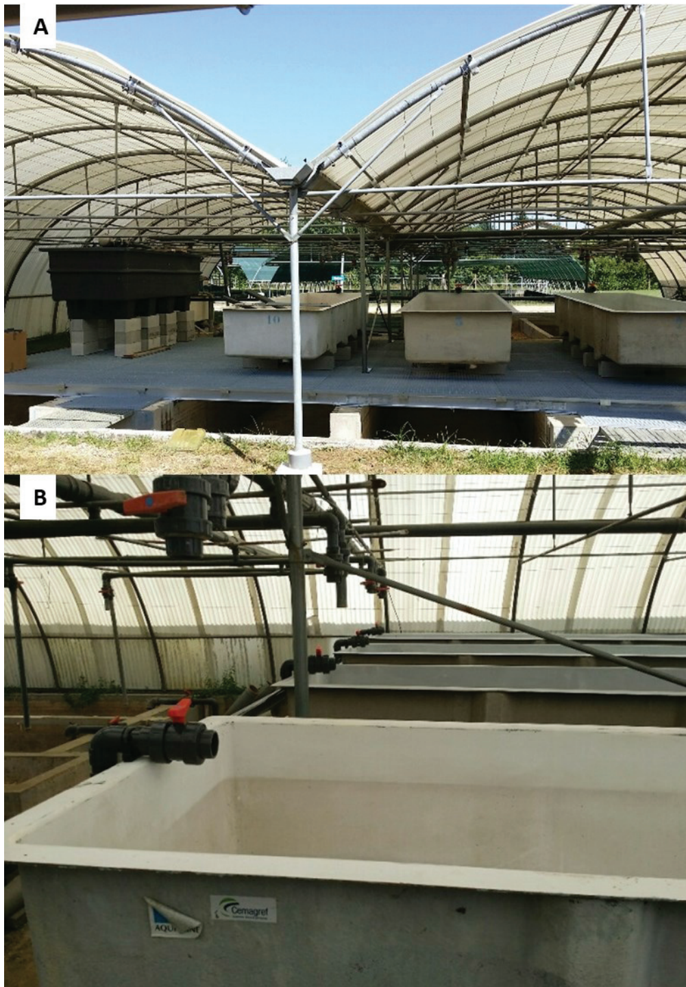
Figure 7. A. Bassins expérimentaux de la plateforme d'Irstea de St-Seurin-sur-l'Isle avec les bassins témoin et contaminé en blanc et le bac tampon en noir. B. Arrivée d'eau des bassins témoin et contaminé.
